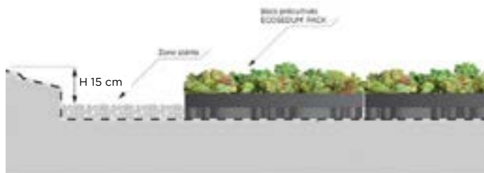
Système ECOSSEDUM PACK et zone stérile en gravillons
